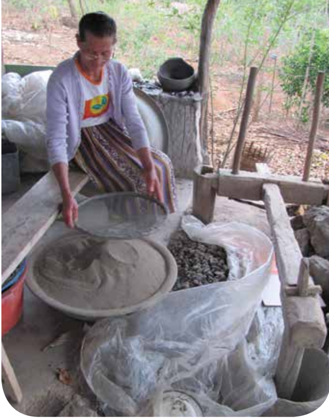
Dona Pedra, artesã da comunidade de Campo Alegre, município de Turmalina, indicando os equipamentos e processo de preparação do barro
