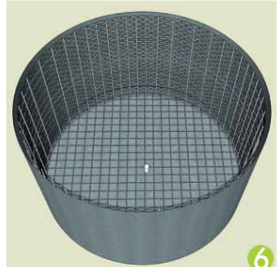
Estrutura de ferro recoberta externamente com massa
